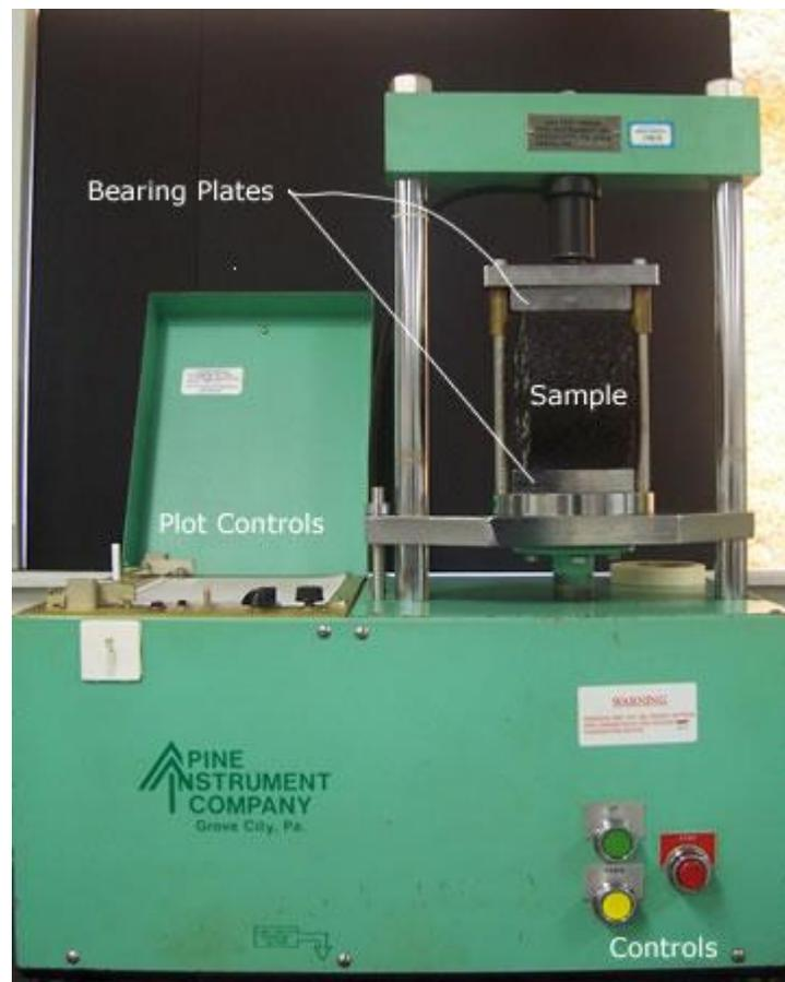
**Figure 16. AASHTO T 283 Test Setup**
