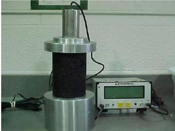
**Figure 14. V-Meter Test Setup**
